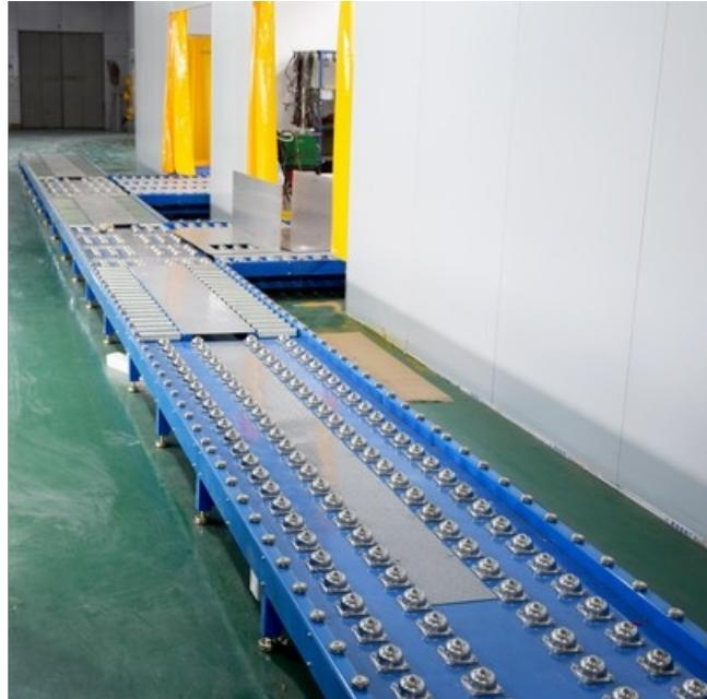
滚筒输送机之间易于衔接过滤，可用多条滚筒线及其它输送设备或专机组组成复杂的物流输送系统以及分流合流系统，完成多方面的工艺需要。可以采用积放滚筒实现物料的堆积输送。滚筒输送机结构简单，可靠性高，使用维护方便，动力滚筒线考虑链条抗拉强度，至长单线长度一般不超过10米。定制滚筒输送机请致电或请确认以下技术参数：1、输送物体的长度、宽度和高度；2、每一输送单元的重量；3、输送物的底部状况；4、有无特殊工作环境上的要求（比如：湿度，高温，化学品的影响等）；5、输送机属于无动力式或电机带动式。
