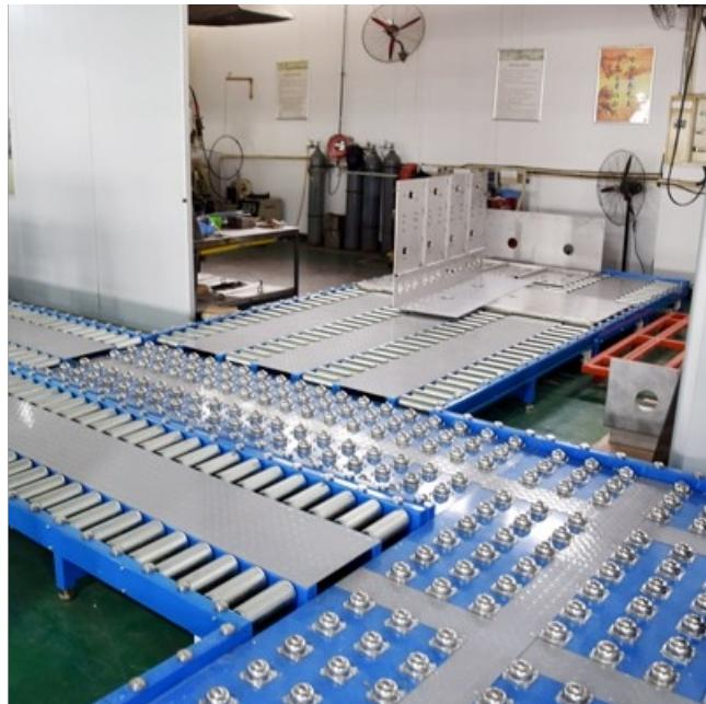
滚筒输送机适用于各类箱、包、托盘等件货的输送，散料、小件物品或不规则的物品需放在托盘上或周转箱内输送。能够输送单件重量很大的物料，或承受较大的冲击载荷，滚筒线之间易于衔接过滤，可用多条滚筒线及其它输送机或专机组组成复杂的物流输送系统，完成多方面的工艺需要。可采用积放滚筒实现物料的堆积输送。滚筒输送机结构简单，可靠性高，使用维护方便。滚筒输送机主要由辊子、机架、支架、驱动部份等组成，辊筒，滚筒输送机是依靠转动着的辊子和物品间的摩擦使物品向前移动. 按其驱动形式可分为无动力滚筒输送机、动力滚筒输送机. 在动力滚筒输送机中，驱动辊子的方法目前一般不在采用单独驱动的方式，而是多采用成组驱动，常用电机与减速器组合，再通过链传动、带传动来驱动辊子旋转. 辊道输送机具有输送量大、速度快、运行轻便等优点，可实现多种类型的共线分流输送；欢迎来电了解详情。揭阳滚筒线流水线
