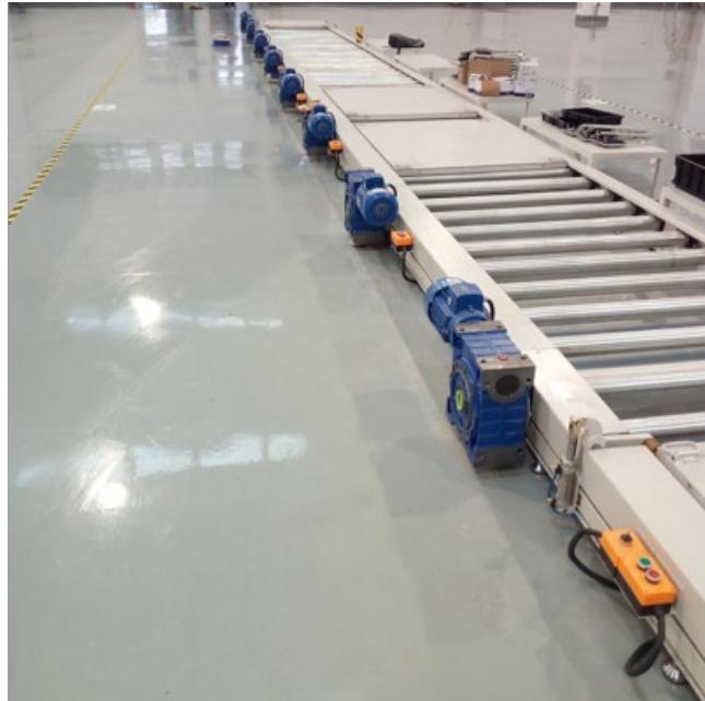
输送滚筒：设备特点：滚筒输送机之间易于衔接过渡，可用多条滚筒线及其它输送设备或专机组成功能复杂的物流输送系统。滚筒输送机适用于底部是平面的物品输送，主要由传动滚筒、机架、支架、驱动装置等部分组成。具有输送量大，速度快，运转轻快，能够实现多品种共线分流输送的特点。结构形式：从驱动形式上分为有动力、无动力、电动滚筒等，按布局形式分为水平输送，倾斜输送和转弯输送。尺寸规格：滚筒输送机内宽度由客户指定，可按客户需求制作，转弯滚线标准转弯内半径为300\600\900\1200mm等，也可按客户需求采用其它特殊规格。直段滚筒所用的滚筒直径有38\50\60\76\89mm等。转弯滚筒的锥度我们会根据输送物体的重量、外形尺寸、线速度等来设计。揭阳滚筒线流水线输送机电动滚筒应该添加哪种油？
